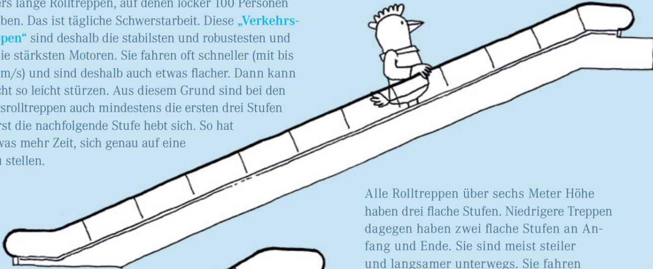
Alle Rolltreppen über sechs Meter Höhe haben drei flache Stufen. Niedrigere Treppen dagegen haben zwei flache Stufen an Anfang und Ende. Sie sind meist steiler und langsamer unterwegs. Sie fahren meist mit 0,4 m/s.
