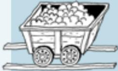
Je mehr Erz man förderte, umso größer und schwerer wurden die Wagen, zu schwer für Holzschienen. Die brachen immer häufiger. Also fertigte man **Eisenschienen**. Daher stammt übrigens der Ausdruck „Eisenbahn“, der früher nur die Schienen meinte. Außerdem überließ man Maultieren und Pferden das anstrengende Ziehen der Lasten.
