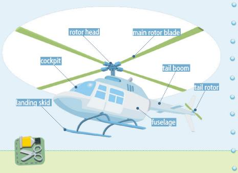
mole hill Maulwurfhügel maple seed Ahornsamen Wiese meadow Auftriebskraft buoyancy angle of attack Anstellwinkel increase, to erhöhen, steigern tilt, to neigen, kippen rotor head Rotorkopf rotor blade Rotorblatt tail boom Leitwerksträger tail rotor Heckrotor landing skid Landekufe Rumpf fuselage Lineal ruler Schere scissors Büroklammer paper clip adhesive tape Klebeband gepunktet dotted arrow Pfeil
