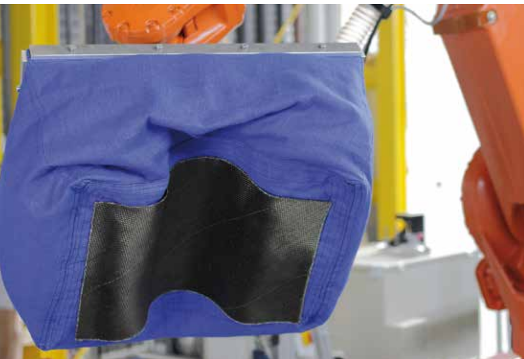
Handhabungssystem, das sich automatisch an die Geometrie und Beschaffenheit von Bauteilen anpasst: die Formhand.
