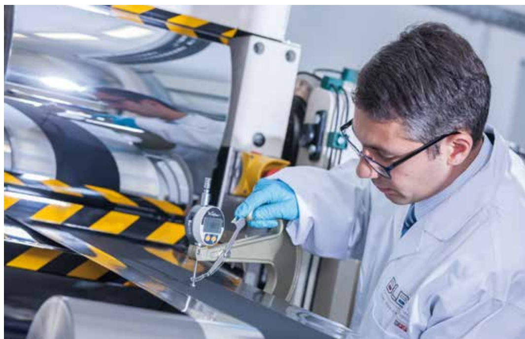
Ein Forscher prüft die gefertigten Elektroden für Lithium-Ionen-Batterien in der Battery LabFactory Braunschweig.
