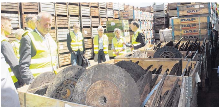
Betriebsrundgang bei ZF Friedrichshafen in Bielefeld. Hier werden Kupplungsdruckplatten und Kupplungsscheiben zu neuwertigen Teilen aufgearbeitet. Foto: VDI LV NRW
