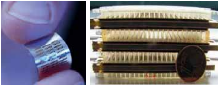
Abb. 21 Links: Prototyp einer planaren Polymer-Elektrolyt-Membran-Mikrobrennstoffzelle (Quelle: Fraunhofer IZM, Berlin; www.izm.fraunhofer.de/fue_ergebnisse/wafer_processing/Mikrobrennstoffzelle.jsp ). Rechts: Stapel aus planaren Leichtbau-Brennstoffzellen (Gewicht 30 g, Leistung 12 W) (Quelle: Fraunhofer IZM/TU Berlin; www.pro-physik.de/Phy/leadArticle.do?laid=10592 )
