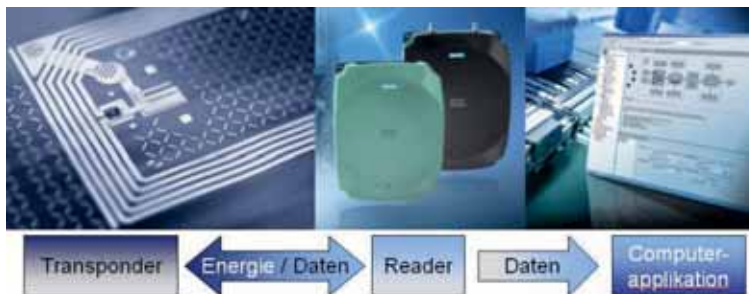
Abb. 5 Komponenten eines RFID-Systems. Links: RFID-Transponder. Mitte: RFID Reader, rechts: Computerapplikation im Bereich Logistik (Quelle: Siemens AG, Bearbeitung durch ZTC der VDI Technologiezentrum GmbH)
