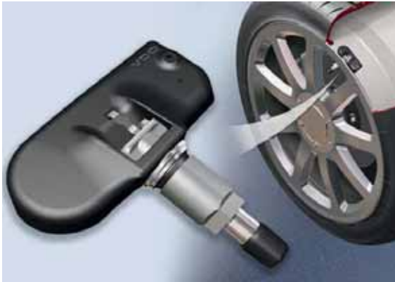
Abb. 15 Reifendrucksensor am Ventil eines Rades (Quelle: Continental Automotive GmbH)
