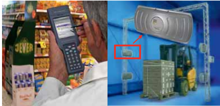
Abb. 8 Links: Handterminal DT-X11 mit RFID-Modul für HF- oder UHF-Tags (Quelle: CASIO Europe, Norderstedt). Rechts: RFID-Reader der Fa. Deister electronics für den Einsatz in RFID-Gates mit einer Reichweite von bis zu fünf Meter (Quelle: Deister electronic GmbH, Bearbeitung durch ZTC der VDI Technologiezentrum GmbH)
