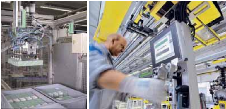
Abb. 12 Links: Bluetooth-Steuerung in der Industrieautomation, digitales I/O-Gerät auf dem Greifer; Bluetooth Basisstation am Rahmen (Quelle: Phoenix Contact GmbH & Co. KG). Rechts: IWLAN-Funknetz in industrieller Anwendung, Einsatz der Technik im Volkswagenwerk Emden (Quelle: Siemens-Pressebild)
