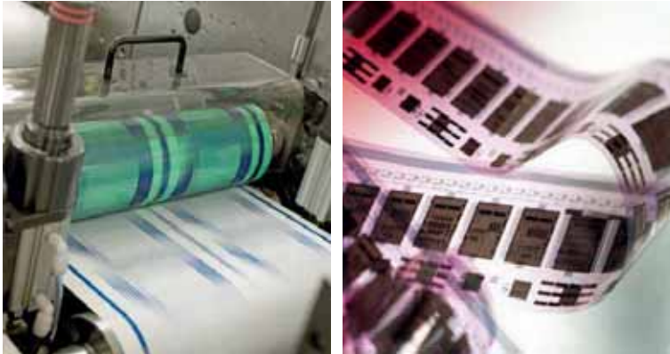
Abb. 19 Gedruckte Elektronik. Links: Druckmaschine für gedruckte Elektronik im Rolle-zu-Rolle Verfahren (Quelle: Acreo AB, Schweden; Copyright Niclas Kindahl). Rechts: Kilometerlange gedruckte Schaltungen für RFID-Tags (Quelle: PolyIC-Pressbild)
