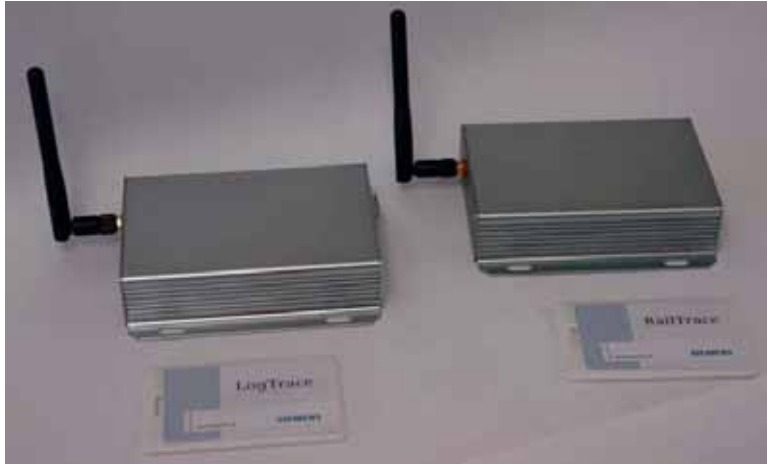
Abb. 7 Aktives RFID-System der Firma Siemens. RFID-Tags in weißen Kunststoffhüllen, Reader in grau/schwarzer Metallhülle (Quelle: Siemens AG)
