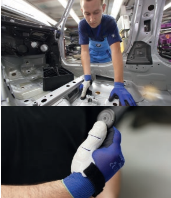
Bild 5. Einsatz der additiven Fertigung in der Automobilindustrie zur optimalen Unterstützung der Mitarbeiter in der Fahrzeugmontage (oben) und Detailaufnahme der Daumenunterstützung (unten) (Quelle: BMW Group Presseclub [c26])
