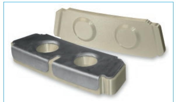
Bild 2. Mittels FDM hergestelltes Kunststoffwerkzeug zur Herstellung eines einzelnen Ersatzteils für die Luftfahrtindustrie (Quelle: Stra tasy/Boeing)
