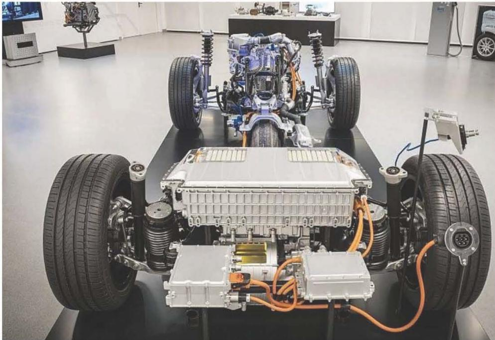
*Foto: Chassis eines Brennstoffzellen-Fahrzeugs*
